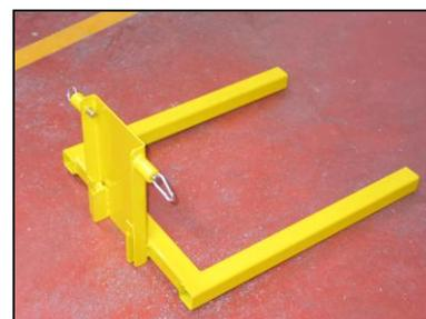
Procedimiento: Desbloquee ambos pestillos laterales, fig 8. Sujete las horquillas con ambas manos y tire hacia arriba hasta que se extraigan, fig 15. Gire las horquillas a la posición invertida e introduzca las horquillas por las ranuras del carro hasta que los pestillos se alojen en su agujero y escuche "click". Fig 16.
