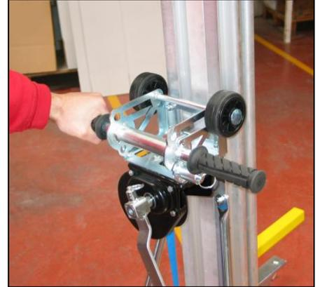
Para desplazar el elevador con carga prestar muchísima atención al área superior, debe estar libre de obstáculos y estar situado en una superficie plana. Descender la carga a la posición más baja antes de proceder el movimiento. No realizar movimientos bruscos. Fijar, sujetar y dejar bien asegurada la carga. Ninguna persona debe de estar, ni debajo, ni alrededor del elevador mientras este en movimiento.
