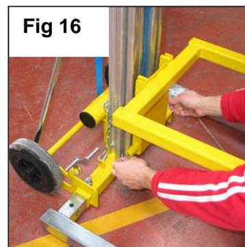
Cada rueda (82019) lleva un freno que se acciona directamente con el pie, solamente hay que presionar el pedal freno (8209) con el pie hasta el fondo, hasta escuchar “click”. Para retirar el freno hay que meter el pie por la parte inferior del pedal freno y empujar hacia arriba hasta que la rueda quede liberada.
