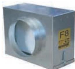
**Módulo filtro compuesto por caja de acero galvanizado plegado a presión, conexiones entrada/salida de sección circular. Filtros compactos tipo bolsa rígida interior caja con medida de papel de fibra de vidrio plisada, cuadro de plástico, sellador de poliuretano. Clases F6 - F7 - F8 - F9 previa solicitud técnica**
