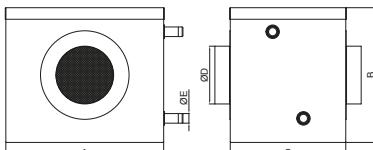
**Módulo batería de agua de pos-refrigeración, compuesto por caja de acero galvanizado plegado a presión, conexiones entrada/salida de sección circular:**
