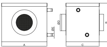
**Módulo batería de agua de pos-calefacción, compuesto por caja de acero galvanizado plegado a presión, conexiones entrada/salida de sección circular.**
